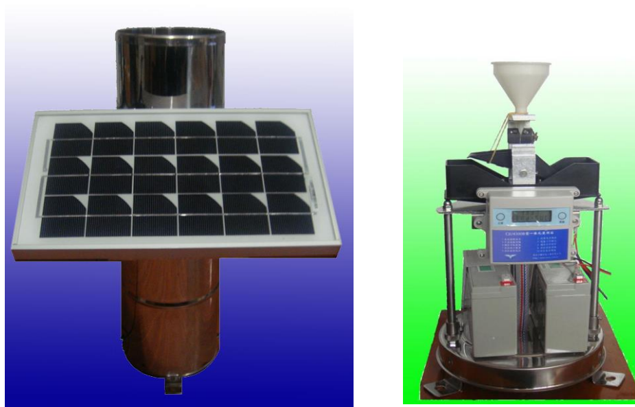
图 1 一体化遥测雨量站组成
